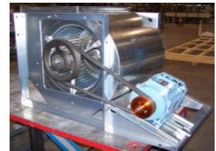
Tren ventilación CCM completo
